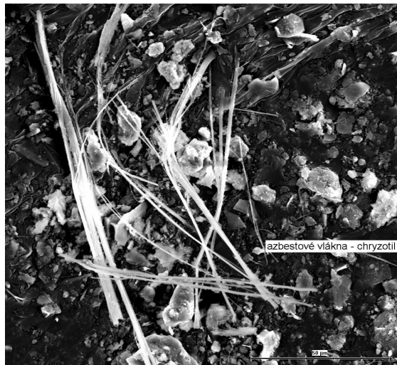
Obr. Chryzotilové vlákna pod rastrovacím elektrónovým mikroskopom
